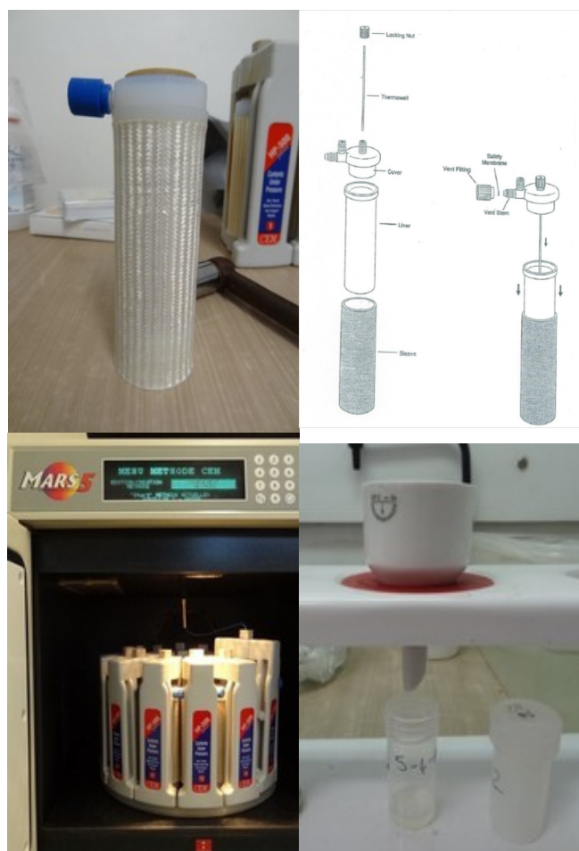
Figure 28 : (a)Creuset et couvercle en téflon (b)Assemblage d'un réacteur de contrôle pour la pression et la température (c) Réacteur placé dans le four micro-onde (d)Filtration des échantillons par capillarité
